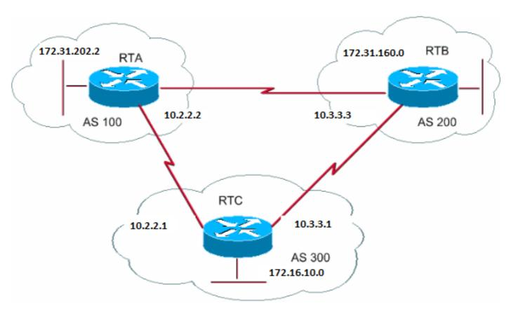
Im vorherigen Diagramm wurde eBGP auf RTA und RTC ausgeführt. RTB und RTC führen eBGP aus. RTA und RTB führen eine Art IGP aus,
