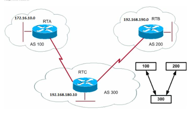
Wenn eine Routenaktualisierung ein AS durchläuft, wird dieser Aktualisierung die AS-Nummer vorangestellt. Das AS\_PATH-Attribut ist die Liste der AS-Nummern, die eine Route durchlaufen hat, um ein Ziel zu erreichen. Ein AS\_SET ist ein geordneter mathematischer Satz {} aller durchlaufenen ASs. Der Abschnitt "CIDR Example 2 (as-set)" dieses Dokuments enthält ein Beispiel für AS\_SET.
