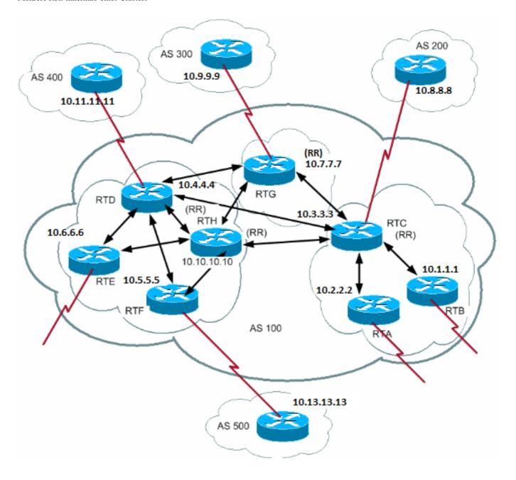
In der Regel verfügt ein Client-Cluster über einen einzigen RR. In diesem Fall identifiziert die Router-ID des RR den Cluster. Um die Redundanz zu erhöhen und Single-Points-of-Failure zu vermeiden, kann ein Cluster mehrere RRs haben. Sie müssen alle RRs im gleichen Cluster mit einer Cluster-ID von 4 Byte konfigurieren, damit ein RR Aktualisierungen von RRs im gleichen Cluster erkennen kann.
