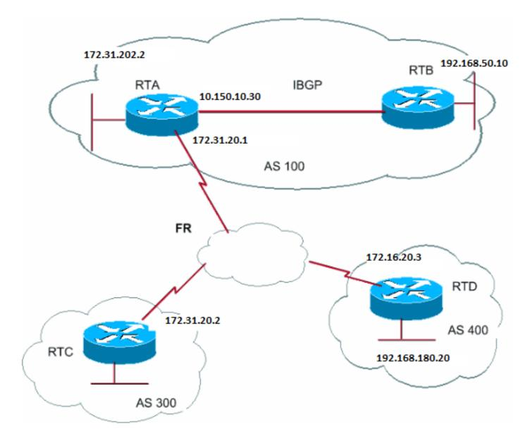
Das gemeinsame Medium erscheint im Diagramm als Wolke. Wenn es sich bei dem gängigen Medium um ein Frame-Relay oder eine beliebige NBMA-Cloud handelt, verhält sich das Gerät genauso, als ob eine Verbindung über Ethernet besteht. RTC kündigt der RTA 192.168.180.20 mit dem nächsten Hop 172.16.20.3 an.
