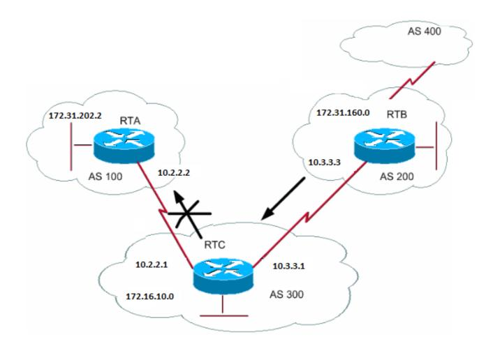
Mithilfe der BGP-AS-Pfade können Sie eine Zugriffsliste für eingehende und ausgehende Updates festlegen. In dem Diagramm in diesem Abschnitt können Sie Updates zu 172.31.160.0 blockieren, sodass sie nicht zu AS100 wechseln. Um die Updates zu blockieren, definieren Sie eine Zugriffsliste auf RTC, die die Übertragung von Updates, die von AS200 stammen, an AS100 verhindert. Führen Sie folgende Befehle aus:
