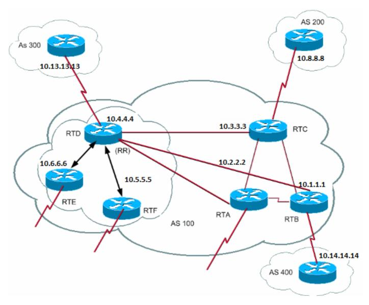
In diesem Diagramm haben RTD, RTE und RTF das Konzept der Routen-Reflektion. RTC, RTA und RTB sind konventionelle Router. Sie können diese Router nicht als RRs konfigurieren. Sie können normale iBGP-Mesh-Verbindungen zwischen diesen Routern und RTD herstellen. Später, wenn Sie bereit sind zu aktualisieren, können Sie RTC ein RR mit Clients RTA und RTB machen. Clients müssen das Routen-Reflexionsschema nicht verstehen; nur die RRs erfordern das Upgrade.
