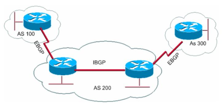
BGP wird zwischen Routern im selben AS ausgeführt
