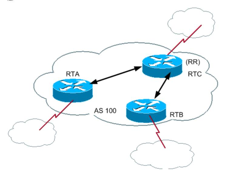
In normalen Fällen muss eine vollständige iBGP-Vermaschung zwischen RTA, RTB und RTC innerhalb von AS100 aufrechterhalten werden. Wenn Sie das RR-Konzept nutzen, kann RTC als RR gewählt werden. Auf diese Weise verfügt RTC über ein partielles iBGP-Peering mit RTA
