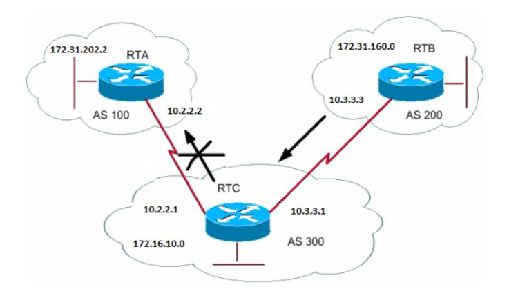
Um die Routing-Informationen einzuschränken, die der Router erhält oder ankündigt, können Sie BGP mithilfe von Routing-Updates für oder von einem bestimmten Nachbarn filtern. Sie definieren eine Zugriffsliste und wenden die Zugriffsliste auf die Aktualisierungen an oder von einem Nachbarn an. Führen Sie diesen Befehl im Router-Konfigurationsmodus aus:
