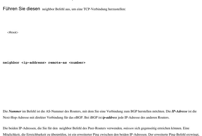
dass der Ping-Router die im Befehl angegebene IP-Adresse als Quelle verwendet neighbor . Der Router muss diese Adresse anstelle der IP-
