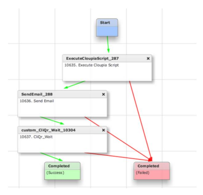
Bei dieser Aufgabe wird die SR-ID an CloudCenter zurückgemeldet. Dadurch kann CloudCenter feststellen, dass der Workflow erfolgreich ausgeführt wurde, und es erhält die ID, die den Workflow rollt.
