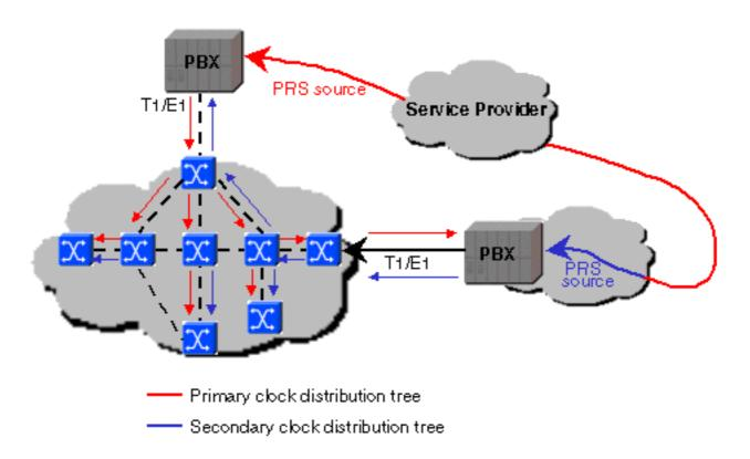
Oszillatoren auf dem 8510-MSR und PA-A2 auf dem Cisco 7200 können Schicht-4-Takt bereitstellen. Der Catalyst 8540-MSR mit dem optionalen Netzwerkuhr-Modul kann eine Schicht-3-Taktquelle bereitstellen. Ohne das optionale Netzwerkuhr-Modul bietet der Catalyst 8540-MSR Schicht-4-Takt. Wenn der Catalyst 8540-MSR mit dem optionalen Netzwerkuhr-Modul ausgestattet ist, kann auch der T1/E1 Building Integrated Timing Supply (BITS)-Port als
