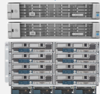
HX240c + B200 в качестве гибридных узлов
