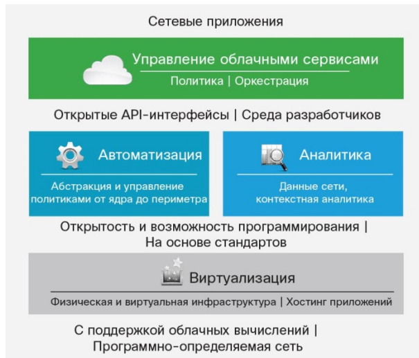
Рис. 1. Архитектура цифровых сетей Cisco DNA
