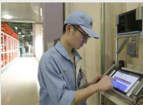
出荷管理情報はタッチパネル式のタブレット端末から無線 LAN を通じてホストコンピューターに集積する
