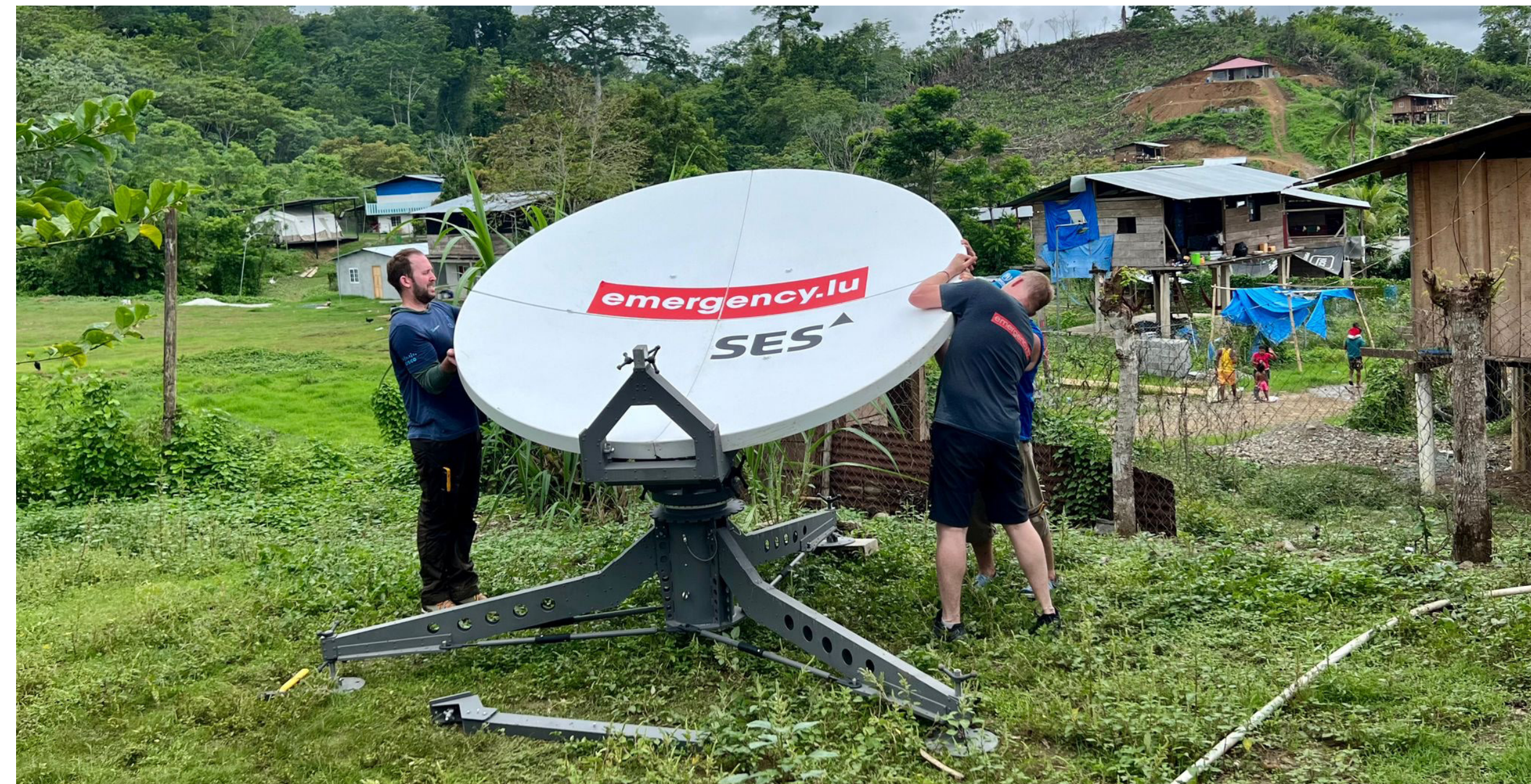
Foto de dos miembros de CCR y emergency.lu mientras ensamblan una terminal satelital en Panamá
