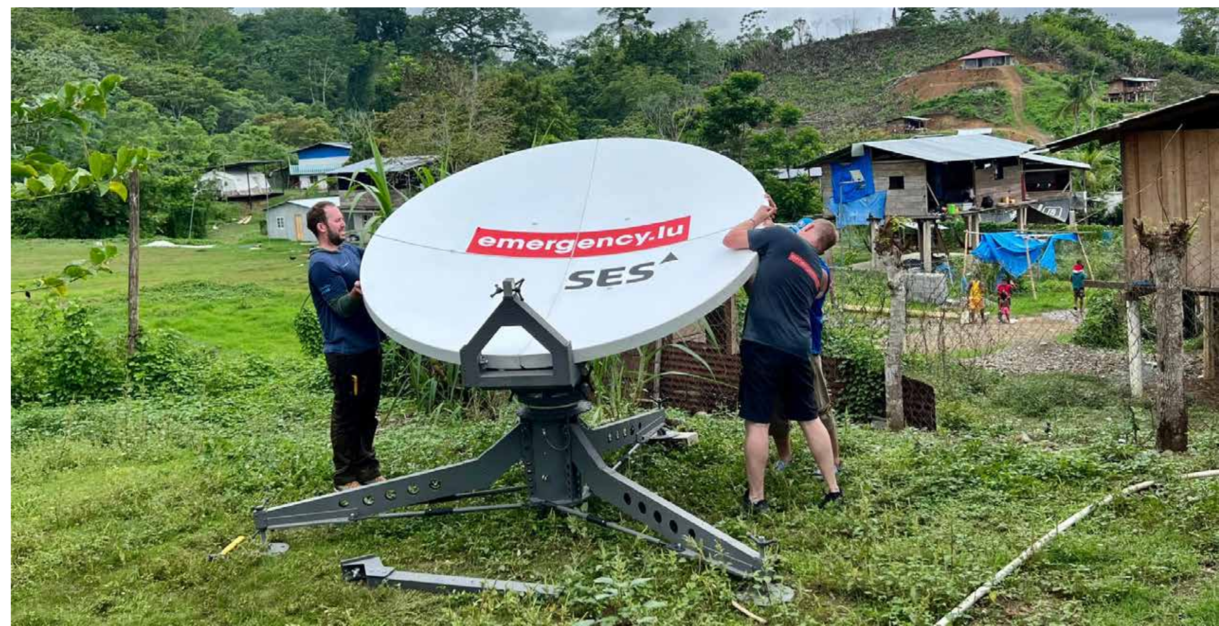
Photo de deux membres de CCR et d'emergency.lu assemblant un terminal satellite au Panorama
