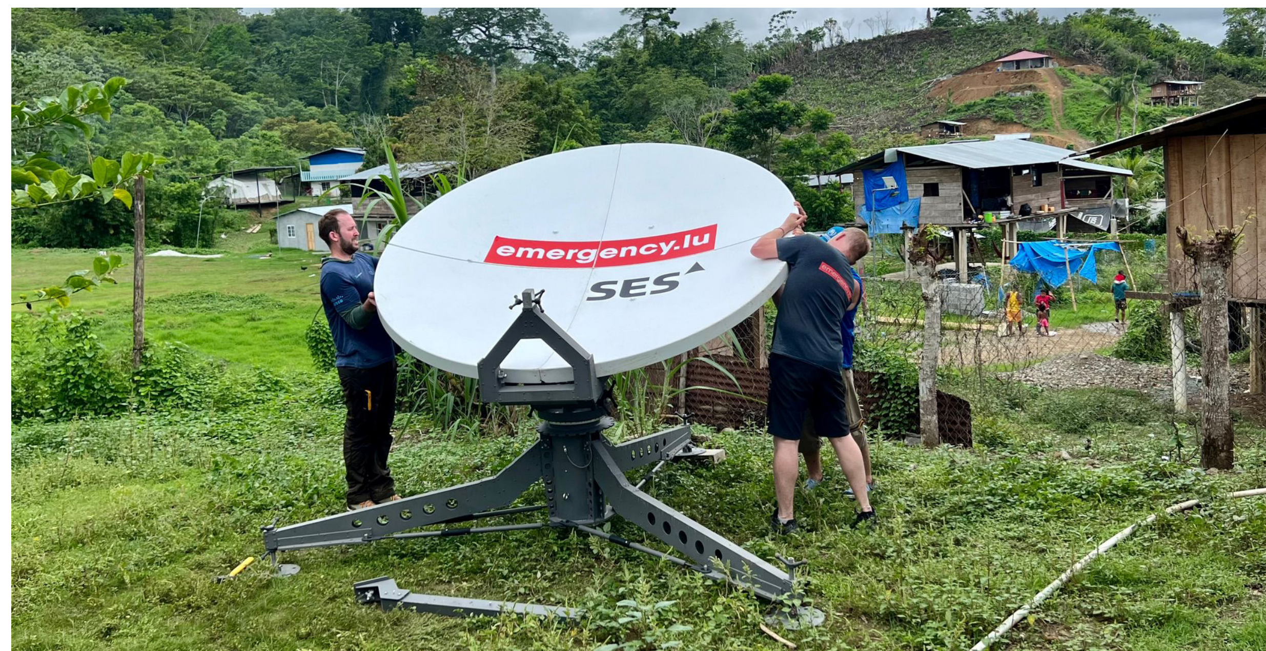
Foto de dois membros do CCR e da emergency.lu montando um terminal de satélite no Panamá
