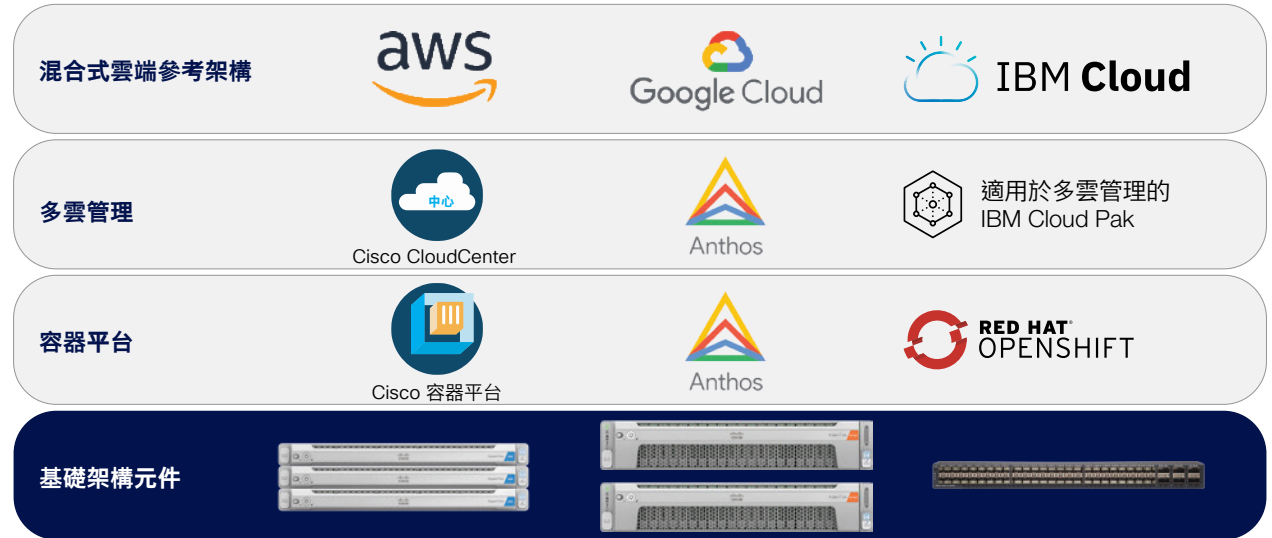
圖 1. 多雲平台元件的結構
