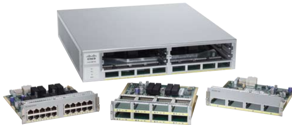
图2 Catalyst 4900M能够提供万兆以太网服务器连接
