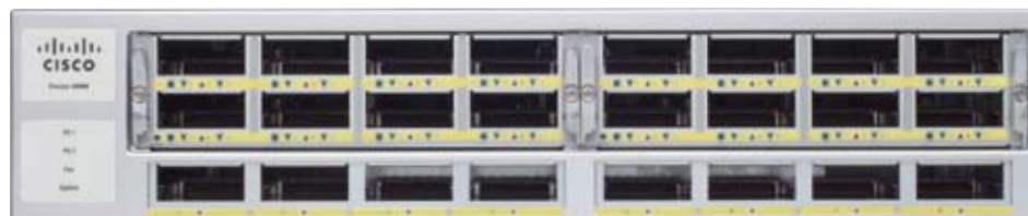
图3 Catalyst 4900M能够在线速下支持40个10/100/1000以太网端口，而且不会导致超额使用
