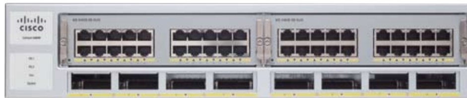
图3 Catalyst 4900M能够在线速下支持40个10/100/1000以太网端口，而且不会导致超额使用
