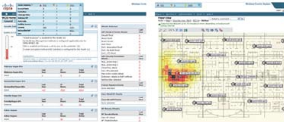
图 5. 持久可用的警报摘要和简化的欺诈设备检测与定位
