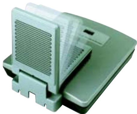
图 5 802.11a 模块提供集成式全向天线和拼接天线
