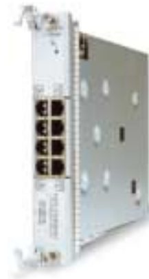
图 1 Cisco 10000 系列 8 端口快速以太网半高线卡
