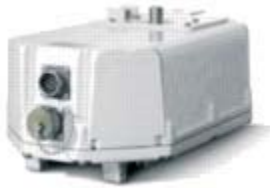
Рисунок 3. “Облегченная” точка доступа Cisco Aironet серии 1500 для ячеистых (mesh) сетей
