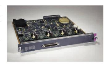
Catalyst 6500 FXS 아날로그 인터페이스 모듈은 아날로그 전화기, 회의실용 스피커 폰, 팩스 장치 등을 연결할 수 있는 24개의 FXS(foreign exchange station) 포트를 갖추고 있습니다. FXS 모듈을 사용하면 재래식 아날로그 장치를 IP 네트워크에 연결할 수 있으므로, 그런 장치들이 IP 네트워크 인프라를 활용하여 전화비 없이 애플리케이션을 사용할 수 있으며 IP 전화기나 H323 엔드 스테이션 등과 같은 장치와 통신을 할 수 있습니다.
