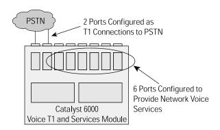
게다가, 음성 T1 및 서비스 모듈은 귀중한 공유 네트워크 자원으로 사용할 수 있습니다. 사용자들은 각 포트를 T1 연결을 위하여 사용할 수도 있고 압축이나 컨퍼런싱과 같은 음성 서비스를 제공하는 네트워크 자원으로 사용할 수도 있습니다(그림 참조). 예를 들어, 네트워크 관리자는 두 개의 포트를 PSTN으로 연결되는 T1 연결로 구성할 수 있습니다. 나머지 여섯 개의 포트는 음성 압축 서비스를 제공하는데 사용할 수 있습니다. 음성 압축 서비스를 이용하면 IP WAN을 통과하는 음성 콜을 압축하여 귀중한 WAN 대역폭을 절약할 수 있습니다. 음성 압축은 이모듈에서 가능한 기능의 한 가지 예에 불과합니다. 이 모듈에서는 현재 설치되어 있는 대부분의 PBX에 존재하는 것보다 더 강력한 프로세싱 능력을 이용할 수 있습니다. 앞으로 개발될 음성서비스를 이용하면 미래의 고급 멀티서비스 네트워크에 새로운 애플리케이션을 배치할 수 있을 것입니다.
