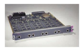
음성 T1 및 서비스 모듈은 PSTN이나 PBX로 연결되는 8개의 T1 포트(192 채널 또는 DSO 음성 트렁크)를 갖추고 있습니다. PSTN이나 구형 PBX로 연결되는 게이트웨이 역할을 하는 이모듈은 IP 네트워크와 주고받는 전송에 대해 음성 패킷화 서비스를 제공합니다. 이 모듈은 ISDN PRI(Primary Rate Interface)나 CAS(Channel Associated Signaling)와 같은 음성 트렁크 프로토콜을 지원합니다. 음성 T1 및 서비스 모듈이설치되어 있는 한 대의 Catalyst 6500 스위치는 전체 캠퍼스를 지원할 수 있는 충분한 음성 트렁킹 파워를 갖추고 있습니다.
