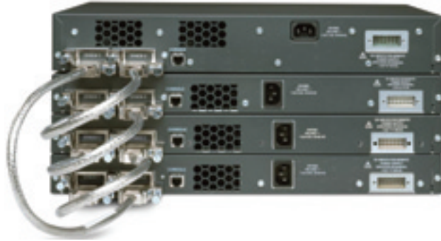
그림 2 Cisco StackWise Technology Resilient Cabling
