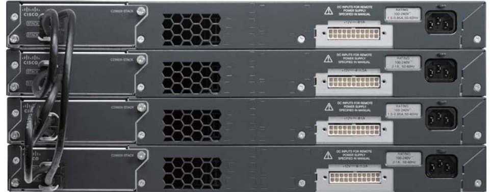
그림 2. Cisco Catalyst 2960-X Series 스위치의 FlexStack-Plus
