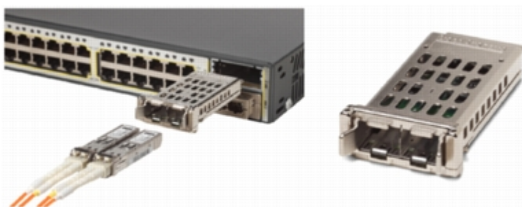
그림 2. 10 기가비트 이더넷 X2 인터페이스를 두 개의 기가비트 이더넷 SFP 인터페이스로 변환하는 Cisco TwinGig 어댑터
