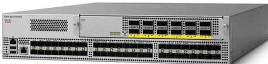
Cisco Nexus93128TX 스위치는 3RU 스위치로서 고정 1/10GBASE-T 포트 96개와 고정 40Gbps QSFP 포트 8개에서 1.28Tbps를 지원합니다(그림 2). 40Gbps 포트는 업링크 모듈에서 제공되며, 사용자가 서비스하고 교체할 수 있습니다. 업링크 모듈은 두 스위치에서 동일합니다. Cisco Nexus 93128TX와 함께 사용할 경우 40Gbps QSFP+ 포트 12개 중 8개를 사용할 수 있습니다.
