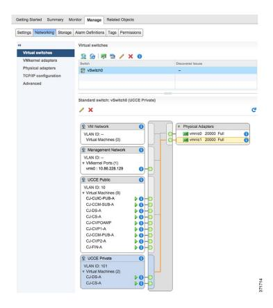
アクティブ/アクティブの vmnic インターフェイスを使用する場合、vSphere Web クライアントの [vSwitch Properties] ダイアログで、アクティブ/スタンバイをポート グループ(VLAN)ごとに設定できます。
