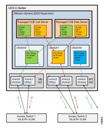
この設計では、ネットワークへの代替および冗長ハードウェアパスを介したアクティブ/スタンバイ構成の仮想マシンのネットワークインターフェイスコントローラ(vmnic)のVMware NIC チーミング(ロード バランシングなし)の使用を求めます。
