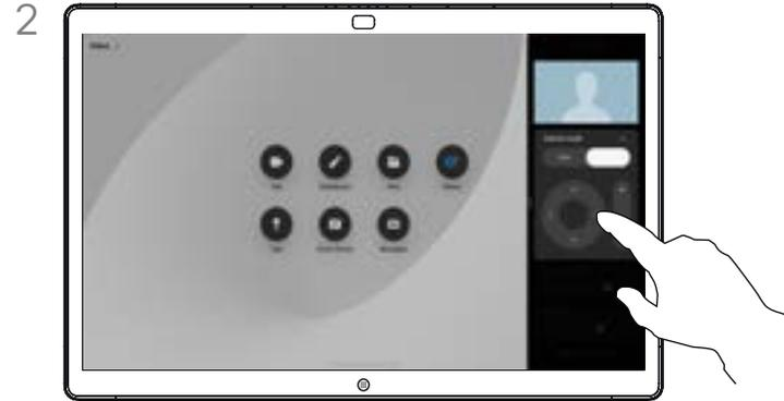
コントロールを使用して、カメラのパン、傾き、ズームを行います。画面の他の場所をタップして終了します。
