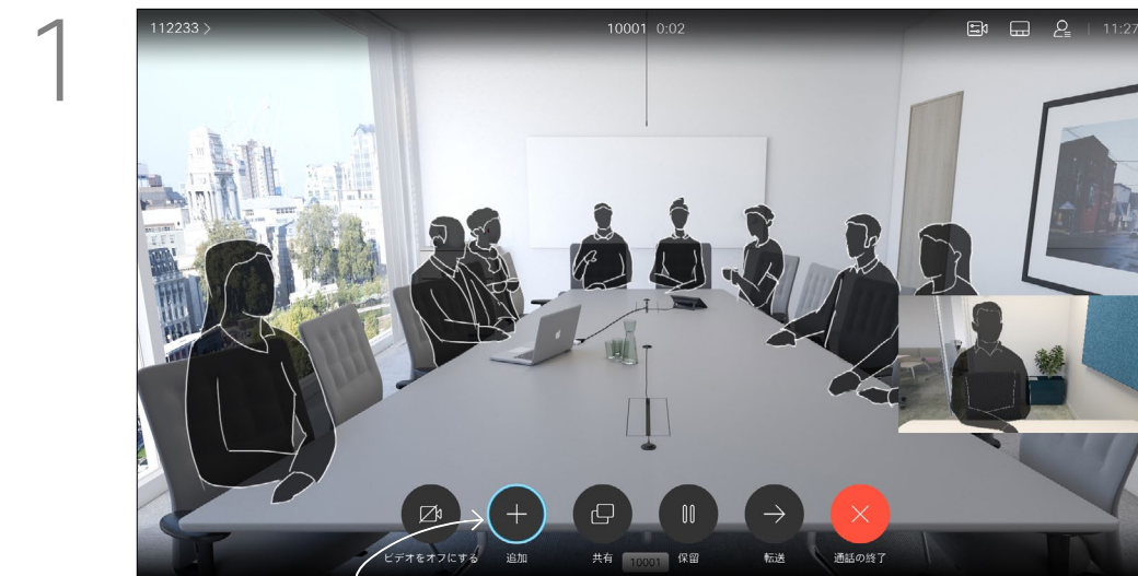
1 通話中に 追加 に移動し、リモコンの OK を押します。現在の通話が保留になります。
