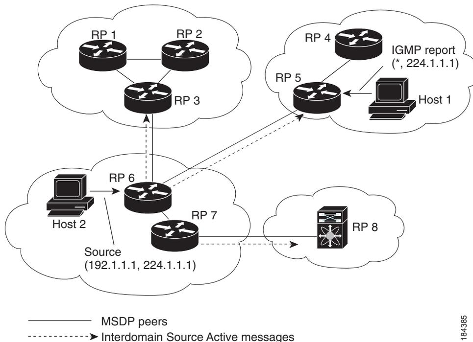
各 RP 間で MSDP ピアリング設定を行うには、フル メッシュを作成します。一般的な MSDP フルメッシュは、RP 1、RP 2、RP 3 のように自律システム内に作成され、自律システム間には作成されません。ループ抑制および MSDP ピア Reverse Path Forwarding (RPF) により、SA メッセージのループを防止するには、BGP を使用します。メッシュ グループの詳細については、「MSDP メッシュ グループ」セクション (5-85 ページ) を参照してください。
