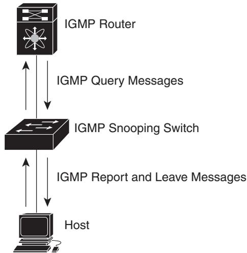
IGMP スヌーピング ソフトウェアは、IGMPv1、IGMPv2、および IGMPv3 コントロールプレーンパケットの処理に関与し、レイヤ3 コントロールプレーンパケットを代行受信して、レイヤ2の転送処理を操作します。
