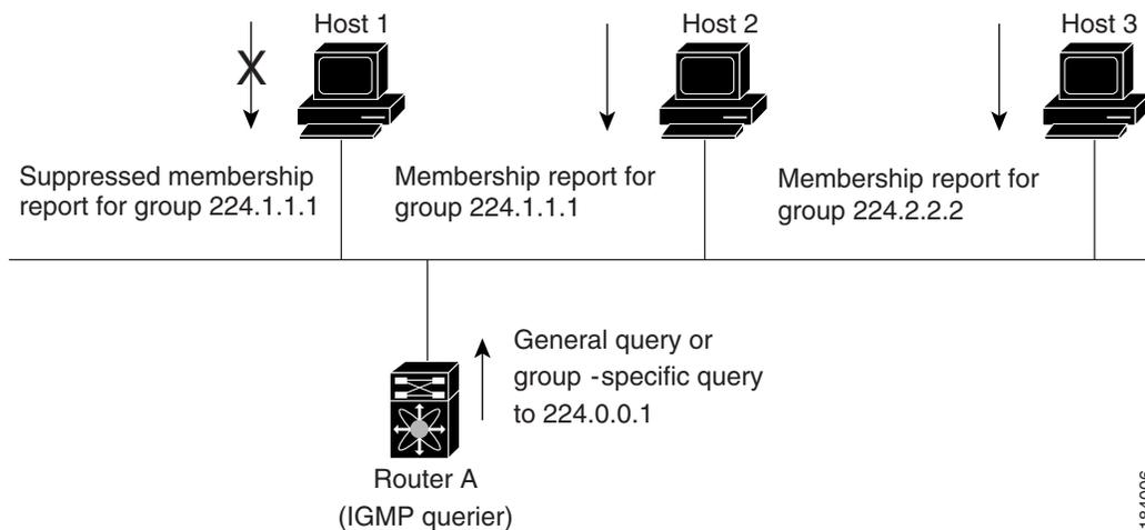
図 2-1 のルータ A (サブネットの代表 IGMP クエリア) は、すべてのホストが含まれる 224.0.0.1 ホスト マルチキャスト グループに定期的にクエリー メッセージを送信して、マルチキャスト データを要求しているホストを検出します。グループ メンバーシップ タイムアウト値を設定し、指定したタイムアウト値が経過すると、ルータはサブネット上にグループのメンバーまたは送信元が存在しないと見なします。IGMP パラメータの設定方法については、「[IGMP インターフェイス パラメータの設定](#)」セクション (2-18 ページ) を参照してください。
