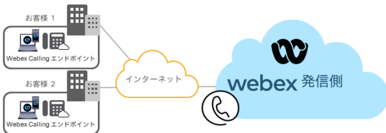
図3 Webex Calling エンドポイントとデータセンター間の OTT (オーバーザトップ) 接続
