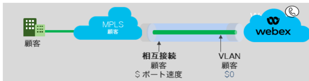
図 2. プロバイダーエッジと Webex Calling 間のパートナー専用の相互接続
