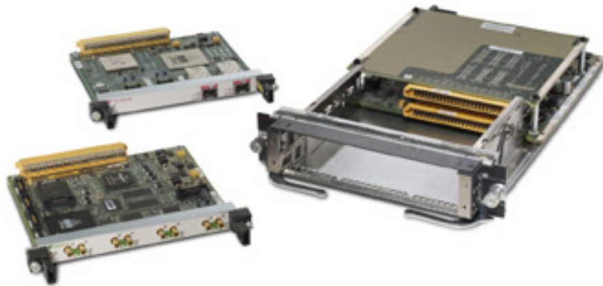
図 1 SPA を搭載した Cisco 7304 SPA MSC
