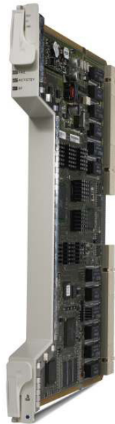
図 1 Cisco ONS 15454 56 ポート DS-1/E1 電気インターフェイス
