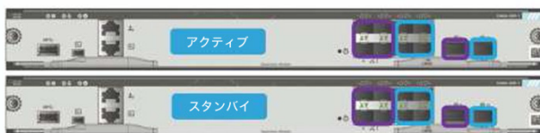
図 デュアル スーパーバイザ アップリンク構成
