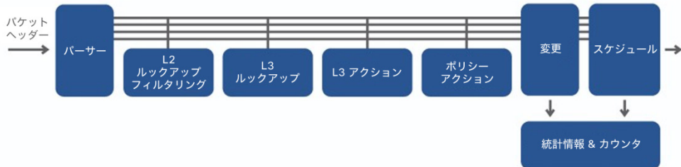
図 従来の ASIC - 処理パイプライン
