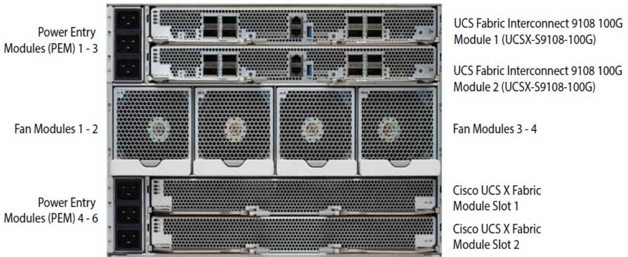
図 5 Cisco UCS X9508 X シリーズ ダイレクトの背面図、UCSX-S9108-100G (上) および 2 つのファブリック モジュール スロット (下) がある
