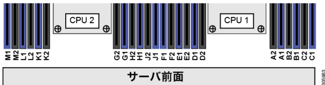
図 3 B200 M5 CPU DIMM チャンネルおよび slot の物理レイアウト
