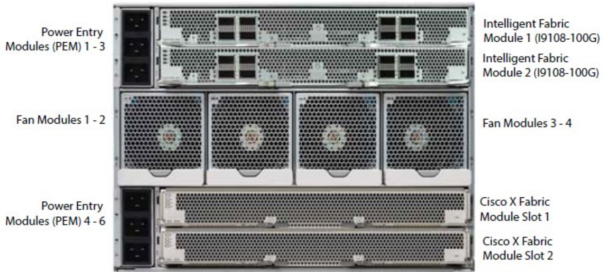
図 4 Cisco UCS X9508 シャーシの背面図。上部に UCSX-I9108-25G、下部に 2 つのファブリック モジュール スロットがある
