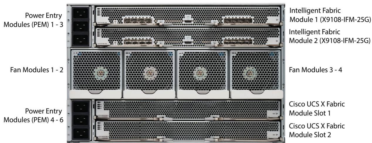
図 4 Cisco UCS X9508 シャーシの背面図、X9108-IFM-25G (上) および 2 つのファブリック モジュール スロット (下)
