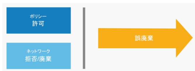
図 12. ポリシーの「許可」とネットワークの「拒否」または「廃棄」の組み合わせは、誤って破棄されたフローを示す
