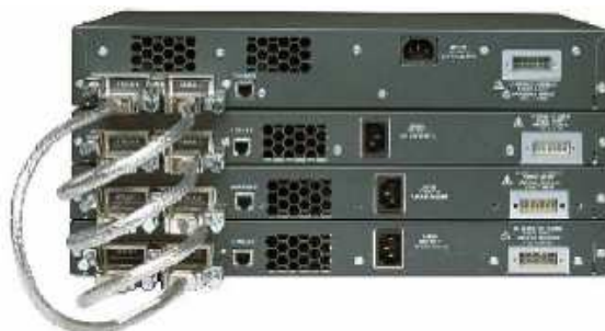
Figure 5. Empilement de commutateurs Cisco Catalyst 3750
