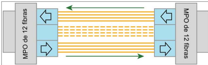
Figura 1. Concepto de los transceptores de 40 Gbps existentes
