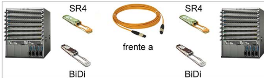
Figura 4. Conexiones directas de 40 Gbps
