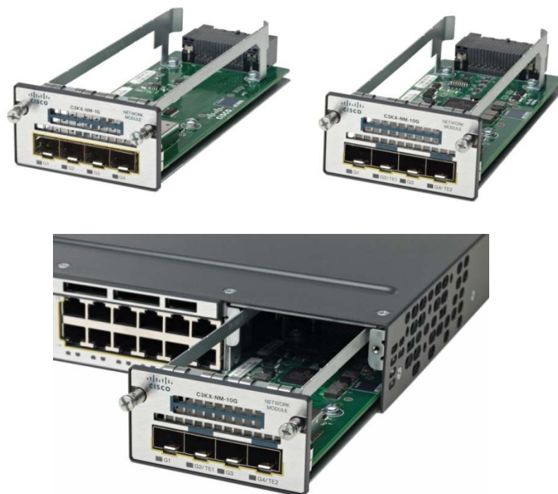
Abbildung 4: Netzwerkmodul mit vier GbE oder zwei 10 GbE SFP+ Schnittstellen
