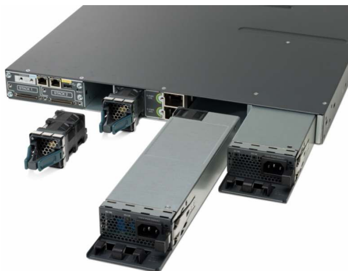
Abbildung 5: Doppelt redundante Stromversorgungen
