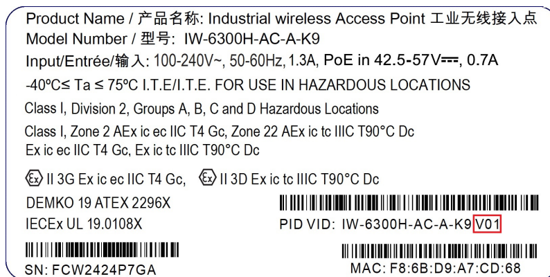
Illustration 1 : Emplacement de l'ID de version sur l'étiquette du point d'accès
