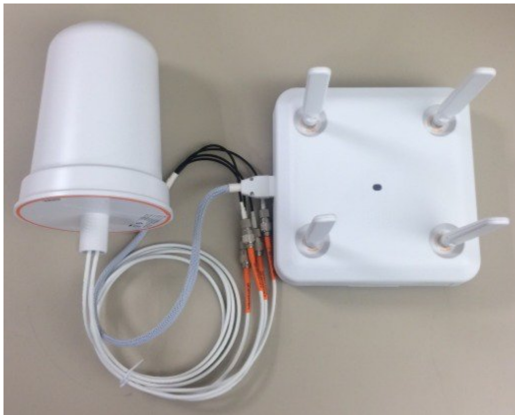
图 43: 智能天线电缆适配器和思科外部全向天线
