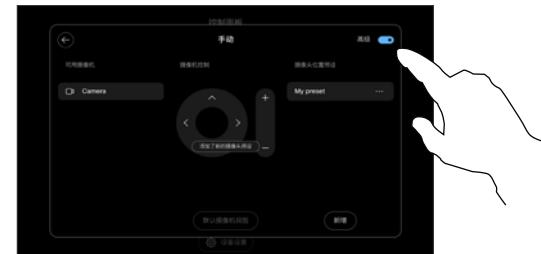
在控制屏幕的右上角开启高级。如果设备使用多个摄像头，请选择左侧的摄像头。使用控制功能来调整平移、倾斜和缩放。
