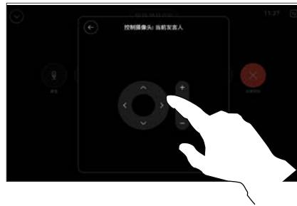
使用摄像机控制按键调整远程摄像机的倾斜、平移和缩放。完成操作后，点击控制以外的任何位置。
