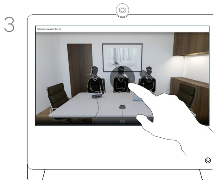
Verwenden Sie die Schwenk-, Kipp- und Zoomsteuerelemente nach Bedarf.
