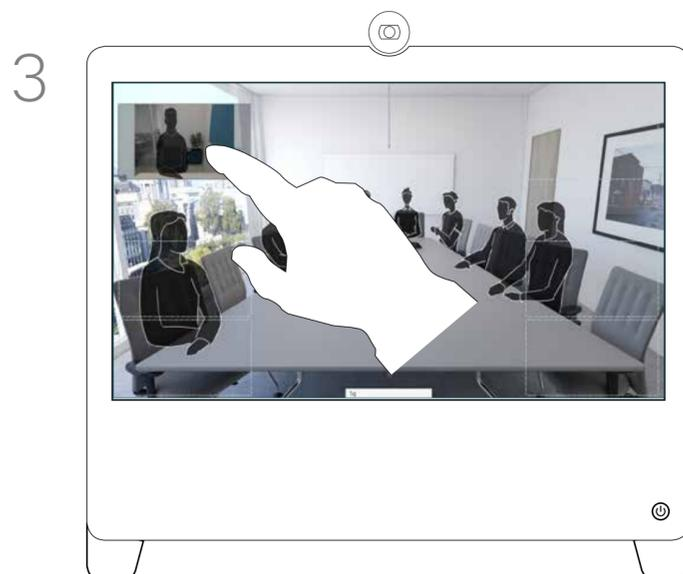
3 Ziehen Sie das Bild an eine neue Position. In diesem Beispiel wird das Bild in die obere linke Ecke verschoben.
