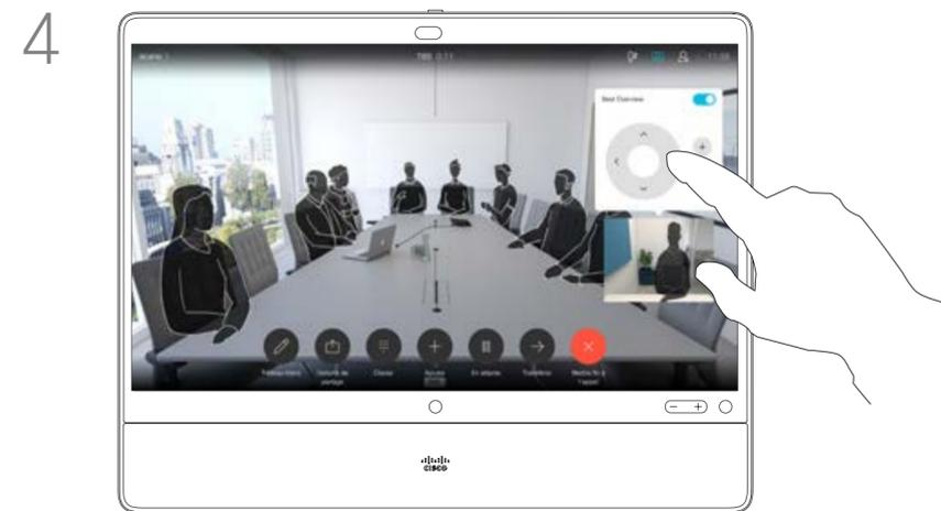
Utilisez les commandes de la caméra pour ajuster le champ, l'inclinaison et le zoom si nécessaire.
