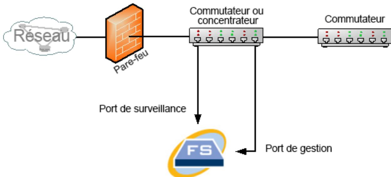
Pour surveiller le trafic à l'intérieur du pare-feu à l'aide d'un port TAP, insérez le port TAP ou le répartiteur optique entre votre pare-feu et le commutateur ou concentrateur principal. Une configuration de port TAP est présentée ci-dessous.
