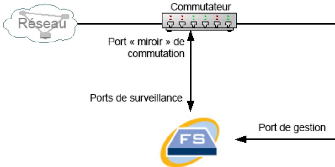
Dans cette configuration, vous devez configurer un port de commutateur (également appelé port miroir) pour répéter l'ensemble du trafic vers et depuis l'hôte copié par le port miroir. Le port 1 du capteur de flux doit être connecté à ce port miroir. Ainsi le capteur de flux surveille le trafic vers et depuis le réseau concerné et vers d'autres réseaux. Dans cet exemple, un réseau peut être constitué de certains ou de tous les hôtes connectés au commutateur.
