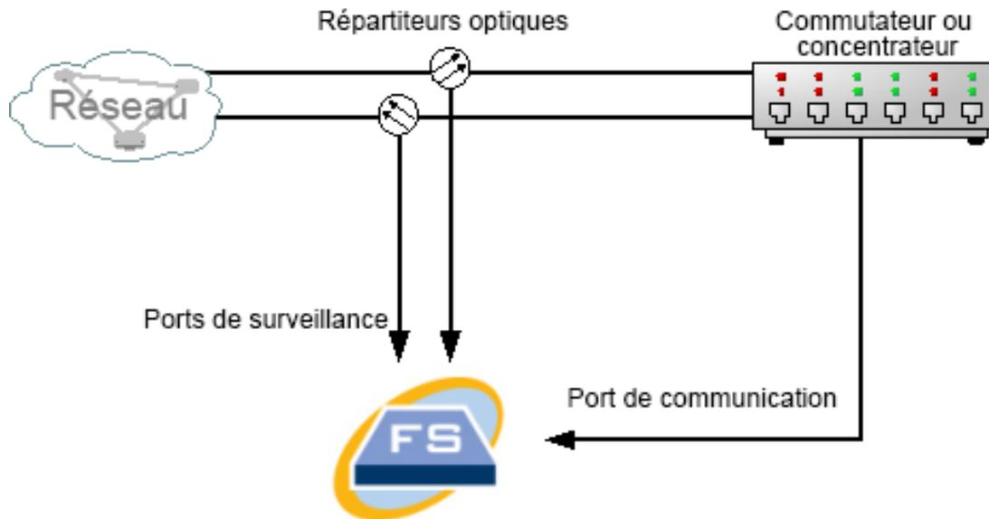
Si la connexion entre les réseaux surveillés est une connexion optique, alors le capteur de flux est connecté à deux répartiteurs optiques. Le port de gestion est connecté soit au commutateur du réseau surveillé, soit à un autre commutateur ou à un concentrateur.
