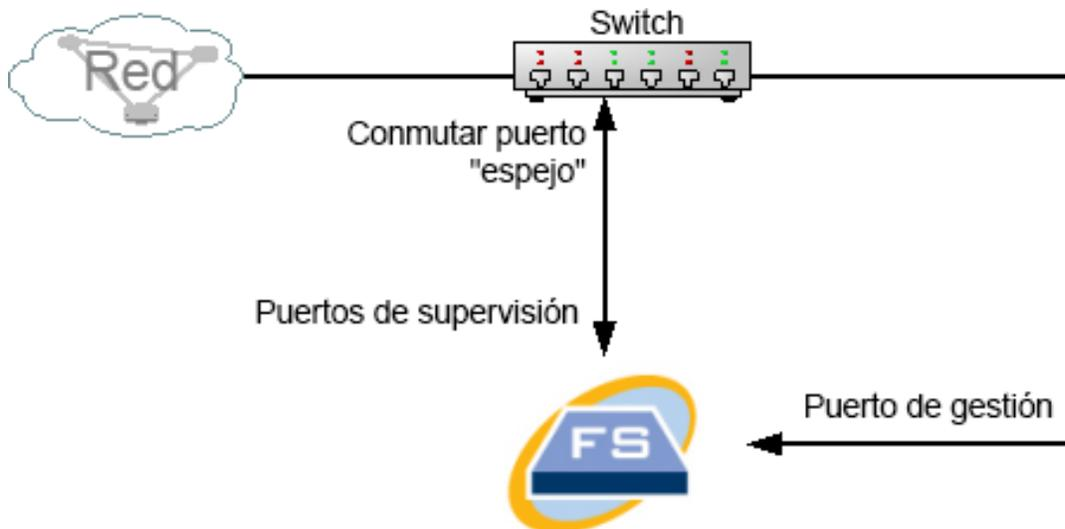
En esta configuración, debe configurar un puerto de switch (también llamado puerto de reflejo) para repetir todo el tráfico de entrada y de salida del host de interés para el puerto de reflejo. El puerto 1 de supervisión del sensor de flujo se debe conectar a este
