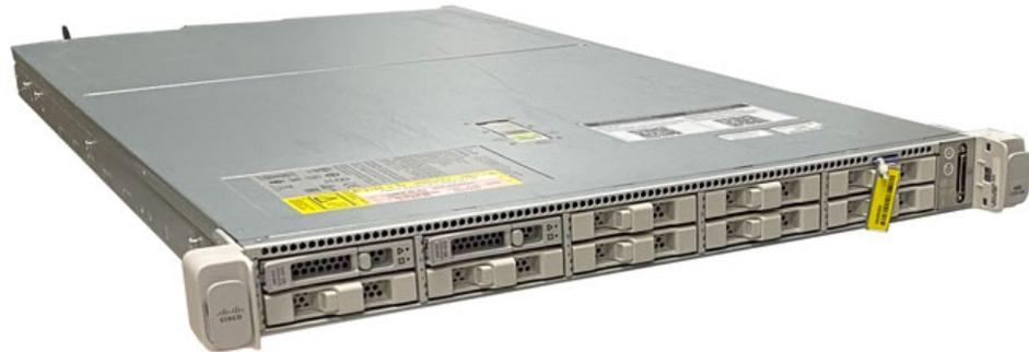
Abbildung 2: Cisco Secure Web Appliance S696 und S696F
