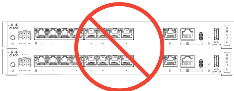
Illustration 29 : Monter le châssis sur un bureau
