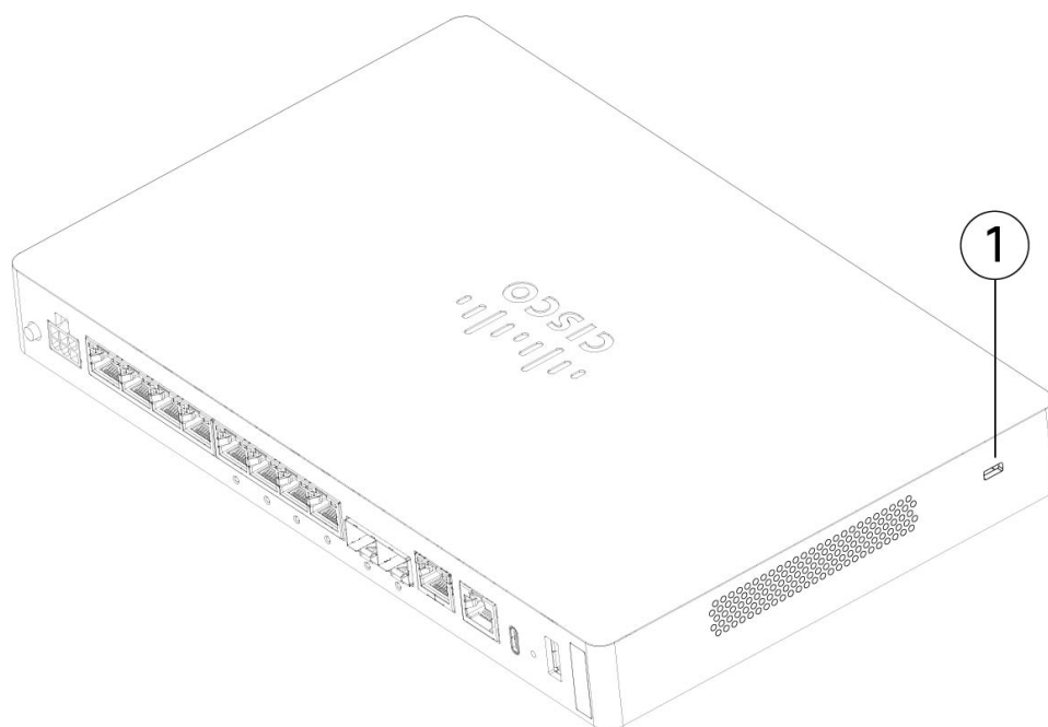
Illustration 3 : Verrouillage Kensington sur le côté gauche du châssis
