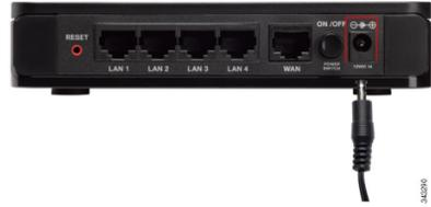
**SCHRITT 6** Stecken Sie den Stecker des Netzteils in eine Steckdose.
