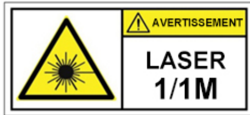
Illustration 15 : Étiquette de produit laser de classe 1M
