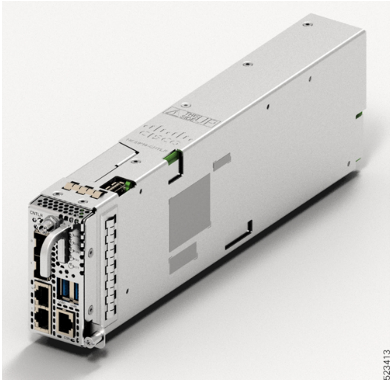
Illustration 43 : Vue en perspective du contrôleur NCS1K14-CNTRL-K9
