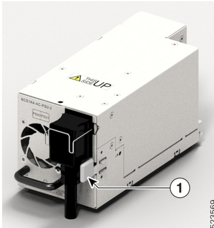
Illustration 64 : Loquet de verrouillage sur le bloc d'alimentation CA
