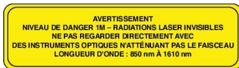
Illustration 4 : Étiquette de produit laser de classe 1M
