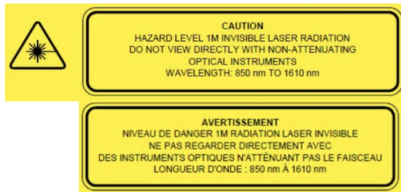
Illustration 15 : Étiquette de produit laser de classe 1M
