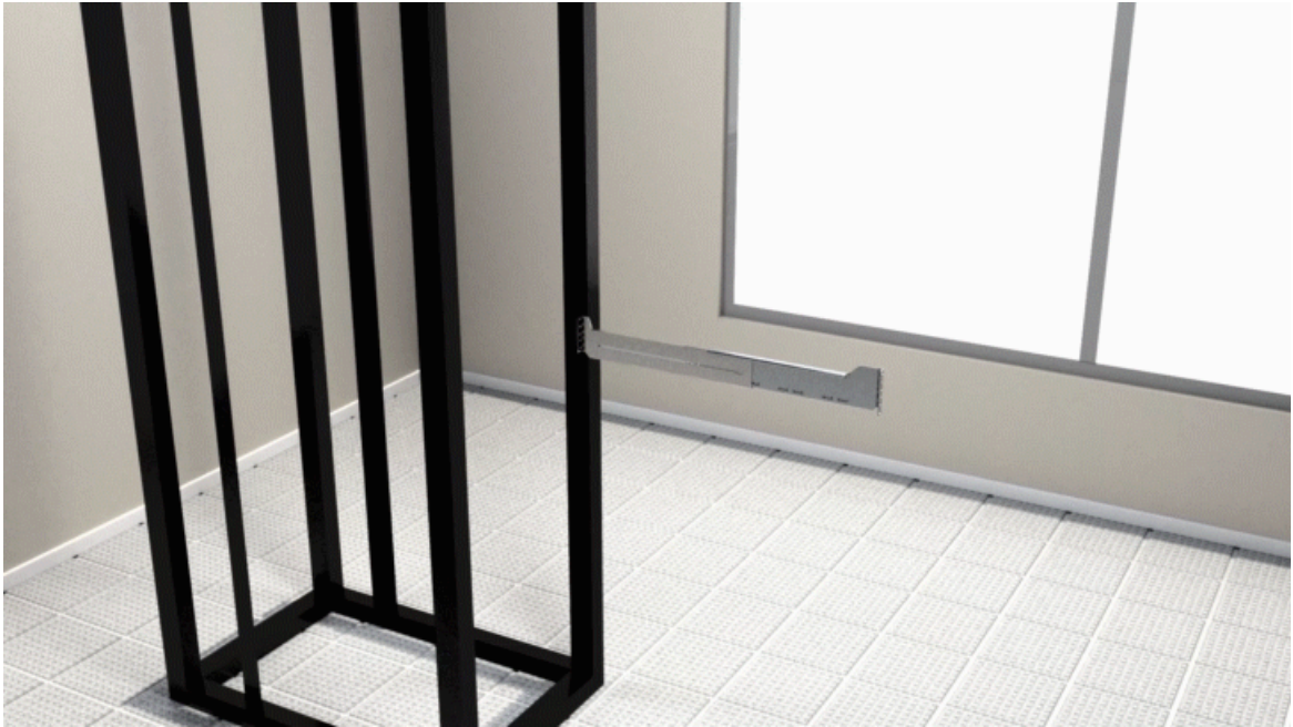
Illustration 35 : Intégration du rail coulissant à quatre montants dans le rack de 23"
