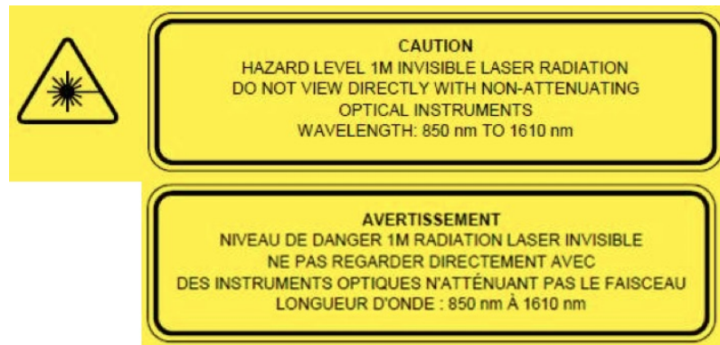
Abbildung 15: Kennzeichnung als Laserprodukt der Klasse 1M
