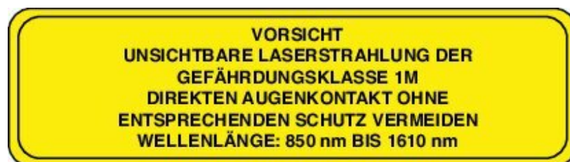
Abbildung 4: Kennzeichnung als Laserprodukt der Klasse 1M
