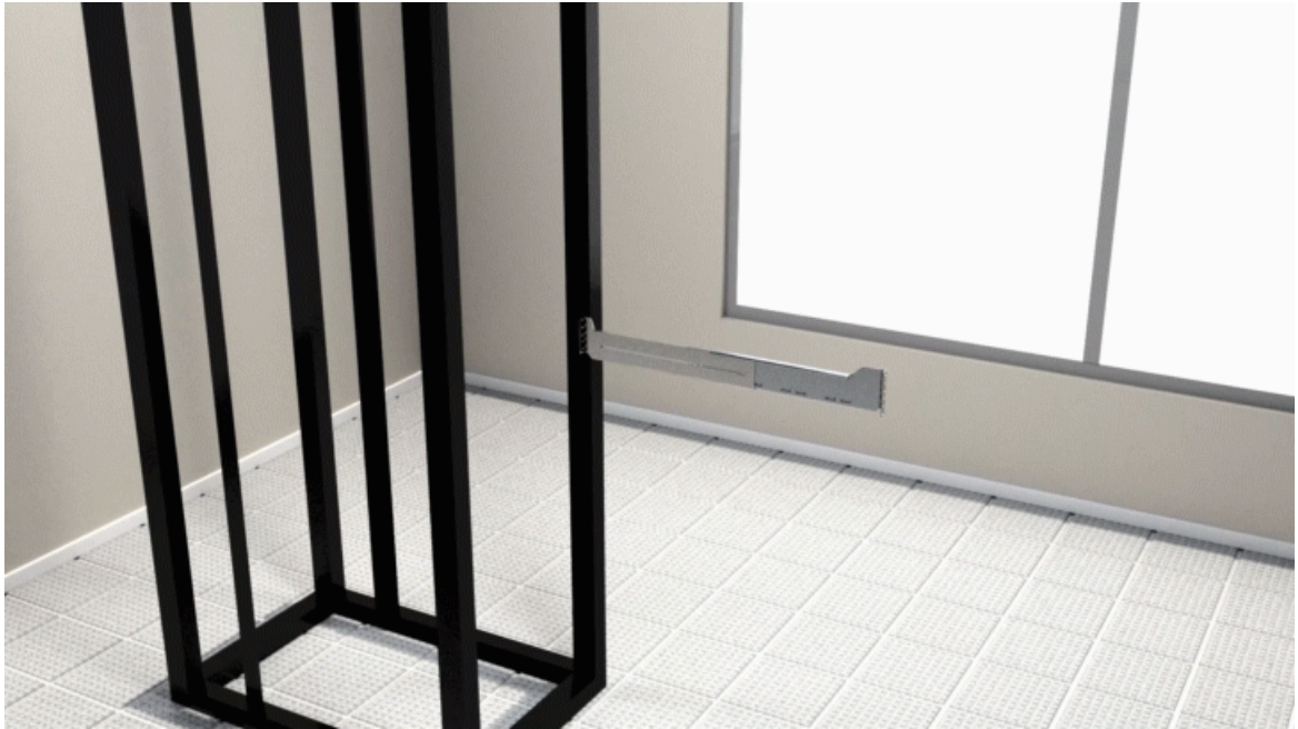
Abbildung 35: Einsetzen der Gleitschiene für vier Säulen im 23"-Rack
